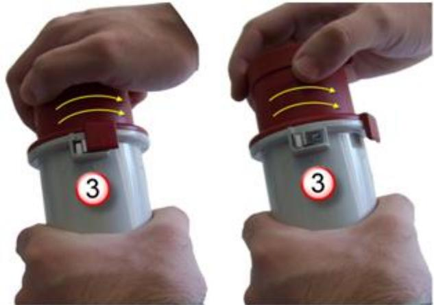
4. Desmonte o plug, desconectando a parte superior da inferior.
